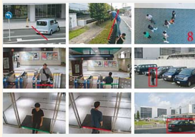
Рис. 1. Возможности видеоаналитики: контроль пересечения виртуальных границ, обнаружение и подсчет объектов, детекция допустимого/недопустимого направления движения
